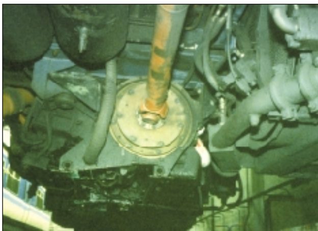
Transport ferroviaire. Accouplement monté entre moteur diesel et transmission par l'intermédiaire d'un arbre à joint universel.
