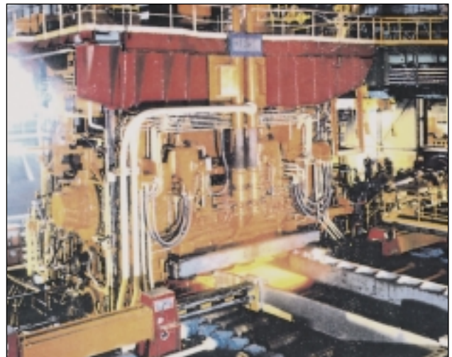
Laminoirs. Accouplements montés entre les mécanismes de commande des tables à rouleaux des laminoirs et les tables de décharge des fours.
