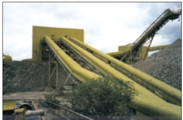
Entraînements de convoyeurs. Accouplements montés sur entraînements de convoyeurs à bande.
